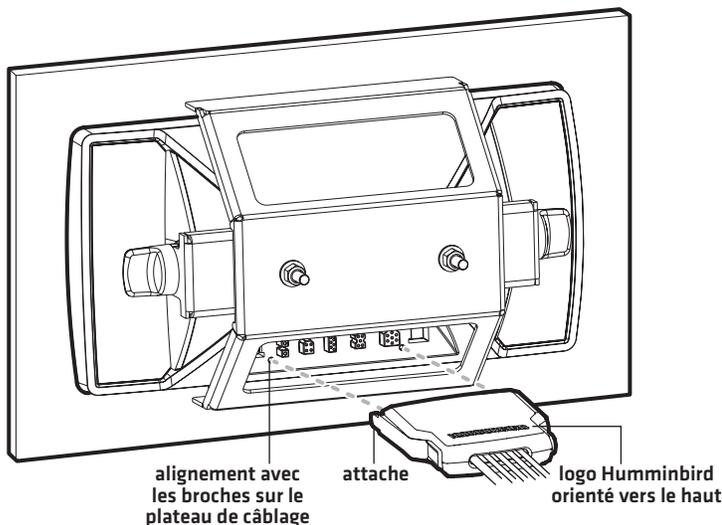
9. Tirez doucement le plateau de câblage pour vérifier que l'illustration est sécurisée. Assurez-vous que les deux attaches émettent un déclic à l'étape 8.
