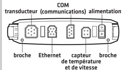
**Insertion des connecteurs de câbles dans le plateau de câblage**
