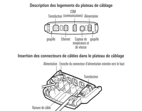
**AVERTISSEMENT** ! Il est important de placer les connecteurs dans les bons logements avec le bon côté orienté vers le haut. Reportez-vous à l'illustration ***Description des logements du plateau de câblage*** pour plus de détails.
