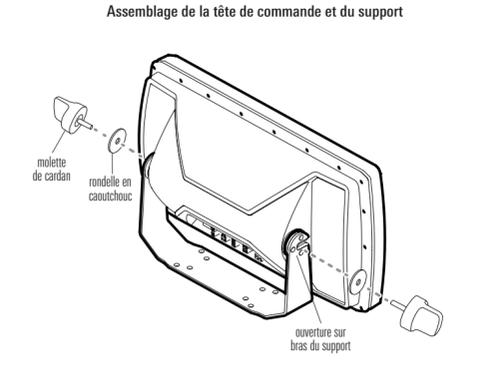
**REMARQUE** : si vous préférez monter le tête de commande en hauteur, faites pivoter le support au-dessus de la tête. L'ouverture dans les bras de support doit faire face à l'arrière de la tête de commande.
