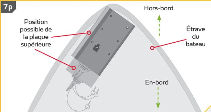
**REMARQUE :** Assurez-vous que le moteur ne rencontrera pas d'obstacles lorsque vous le faites glisser sur le support à dégagement rapide. L'emplacement précis du moteur et du support à dégagement rapide à commande électrique peut varier selon le bateau, le pont du bateau et l'extrusion de la base ou le support auquel est monté le support à dégagement rapide. Le moteur Ultrera ne peut pas être déployé avant le montage et la connexion à une source d'alimentation.
