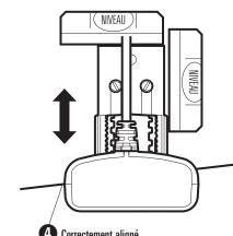
Inclinaison vers le bas: Le transducteur e une déclivité naturelle de 4 à 5 degrés du bord d'attaque au bord de fuite. D'un point de vue situé à l'arrière du transducteur, la ligne de joint devrait être légèrement sous le fond de la coque.
