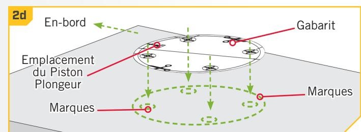
**AVIS :** Percez les trous pour les vis complètement au travers afin d'empêcher des fissures du pont du bateau.
