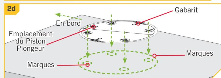
**AVIS :** Percez les trous pour les vis complètement au travers afin d'empêcher des fissures du pont du bateau.
