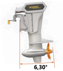
Fig. 23: Motorn har vippats ända ner
