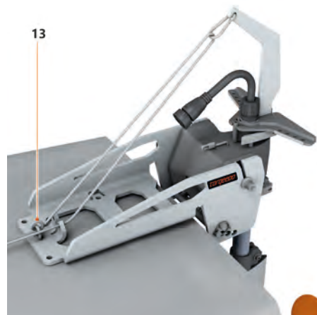
Fig. 71: Tração por cabo nos modelos 1103 AC
