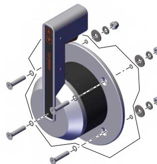
Abb. 6: Explosionszeichnung Ferngashebel
