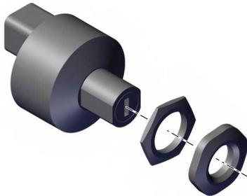
Abb. 12: Explosionszeichnung Schlüsselschalter
