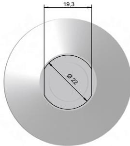
Abb. 11: Einbauzeichnung Schlüsselschalter
