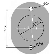
Abb. 9: Einbauzeichnung Kill-Switch
