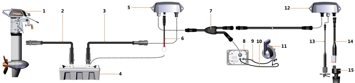
Abb. 13: Verkabelung der Ferngas-Einheit
