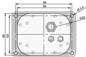
Abb. 7: Einbauzeichnung Display
