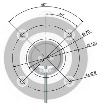
Abb. 5: Einbauzeichnung Ferngashebel
