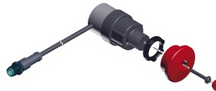
Abb. 10: Explosionszeichnung Not-Aus-Schalter
