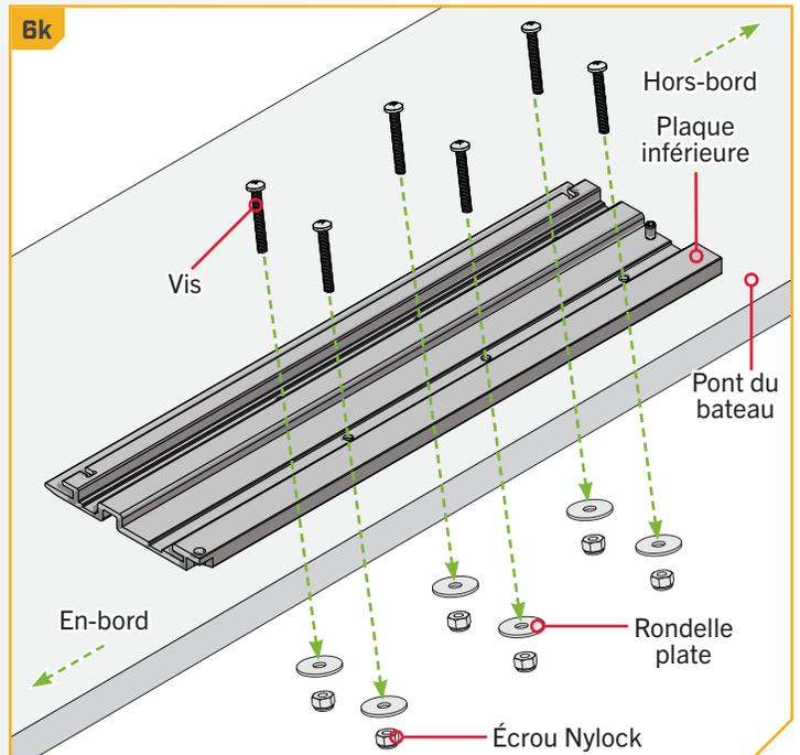
**AVIS :** La surface de montage pour la plaque inférieure doit être complètement plate; autrement, la plaque supérieure ne sera pas bien placée. Des rondelles en caoutchouc peuvent être utilisées pour caler la plaque inférieure afin qu'elle soit à plat avant le serrage de la quincaillerie.
